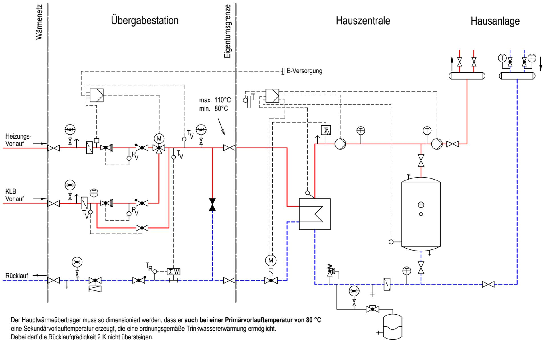
Der Hauptwärmeübertrager muss so dimensioniert werden, dass er **auch bei einer Primärvorlauftemperatur von 80 °C** eine Sekundärvorlauftemperatur erzeugt, die eine ordnungsgemäße Trinkwassererwärmung ermöglicht.
